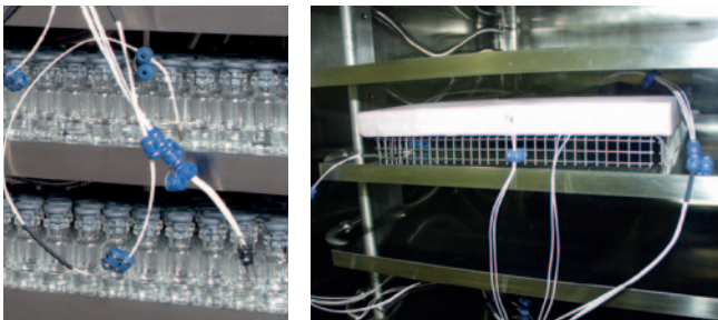
Abbildung 5.4 Produktfühler in einer ca. 1 cm hoch mit Wirkstoff befüllten Rollrandflasche sowie in einem schwammartigen Produkt
