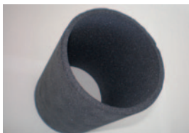
Zylinder aus poröser Spezialkeramik (Zwischenstufe, kein fertiges Produkt)
