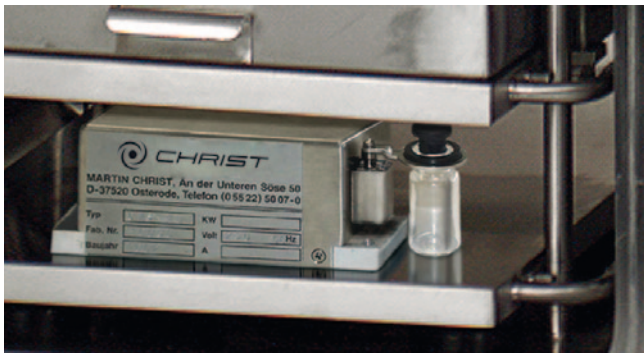
Abbildung 5.8 Mikrowaage von Christ zur Messung von Vials und kleinen Schalen
