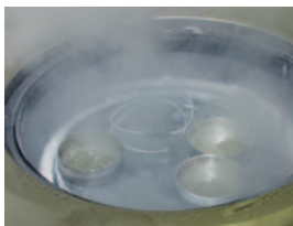
Schock-Einfrieren von Pflanzenpollen in einem Laborgefrier-trockner unter Zuhilfenahme von LN 2
