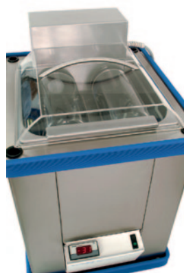
Abbildung 5.3 Kühlbad zum Einfrieren der Rundkolben oder Weithalsflaschen unter Rotation
